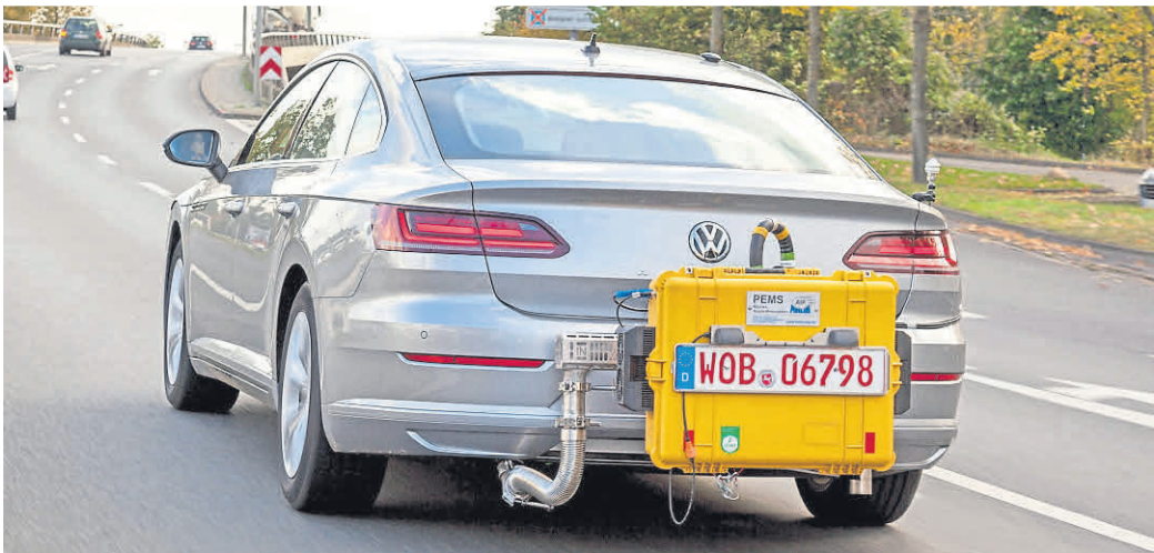
WLTP-Abgastest: Ein VW Arteon ist mit den Testgeräten unterwegs.
